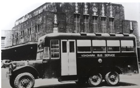
アメリカ軍払い下げの6輪駆動トラックを改造したバス（昭和21年頃）
